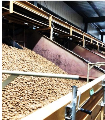
ドライヤー室に入れ熱風で乾燥（室温43℃～44℃）乾燥時間は35時間～40時間で水分量は機械で管理されている。
