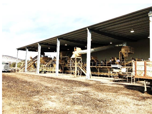
ハリングラインで洗浄・外皮除去を一連で行う。3台のカメラが設置されており色で良品・不良品を判別。
